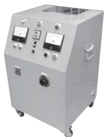
IPK-30D 特注品(参考仕様) 外形寸法・重量 : 500(W) × 500(D) × 790(H)mm ・ 約60kg
