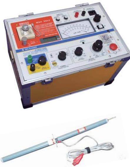
試験後の放電用に40kVまで対応可能な「MTS-3W」が付属します。
