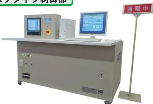
写真の「制御部」でループ(試験回路)の電流・電圧を制御します
